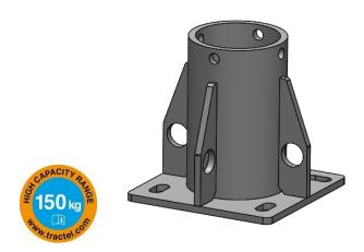
L'embase de sol Davitrac™ / Davimast™ se fixe au sol avec 4 chevilles chimiques pour charge lourde de diamètre 16 mm.
